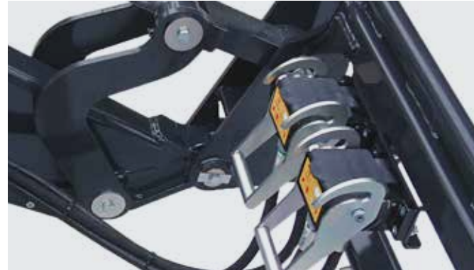
Aprīkojums Fix 2-kāršs savienojums 3. un 4. hidrauliskajam izvadam.
