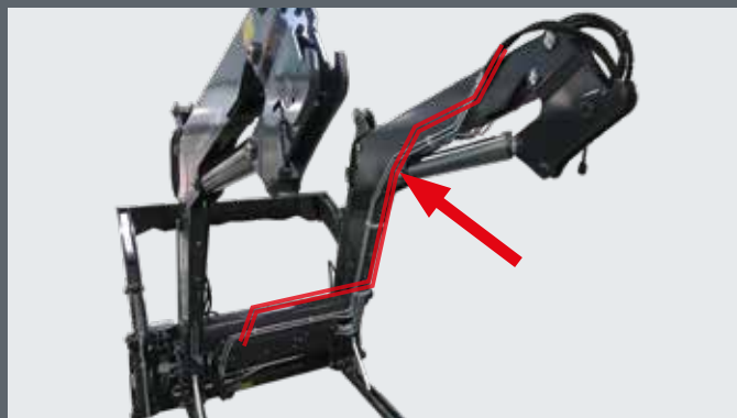
Īsts trešais hidrauliskais izvads: REALS 3
