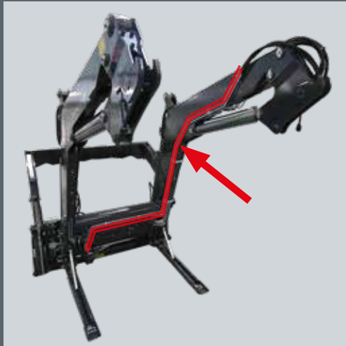
Cauruļu iekļāšana REAL 3 rd
